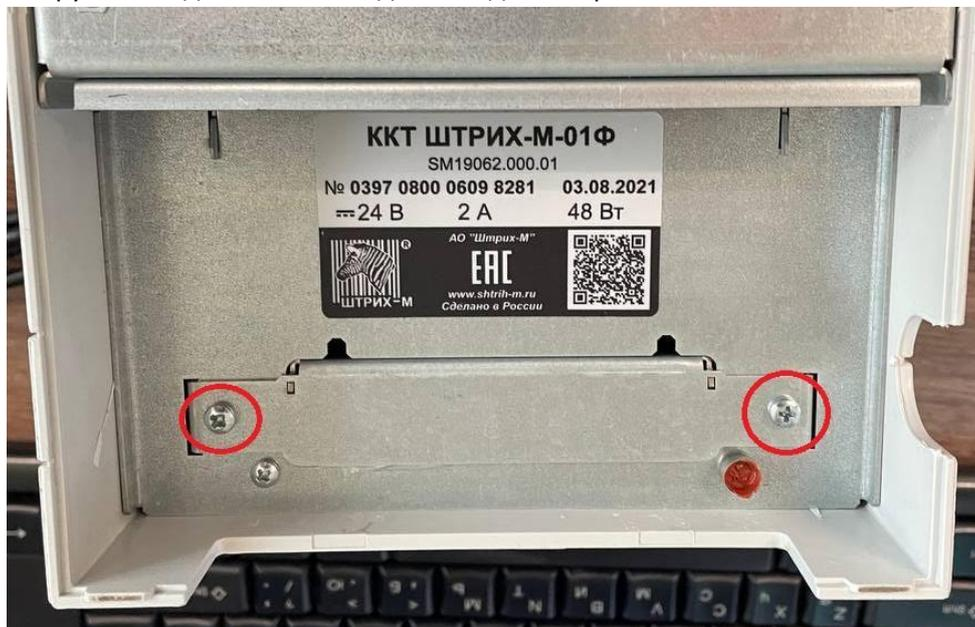
3. Вытаскиваем ФН, выкручиваем винты из пластмассового крепления.
