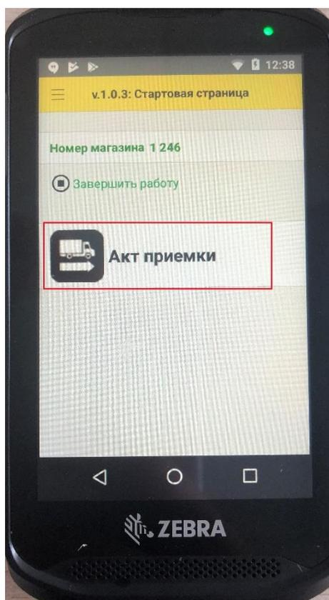
10) После чего начинаем сканирование марок (Нужно сканировать только новые марки!). Сканирование производится посредством нажатия желтых кнопок, которые находятся по бокам ТСД.
